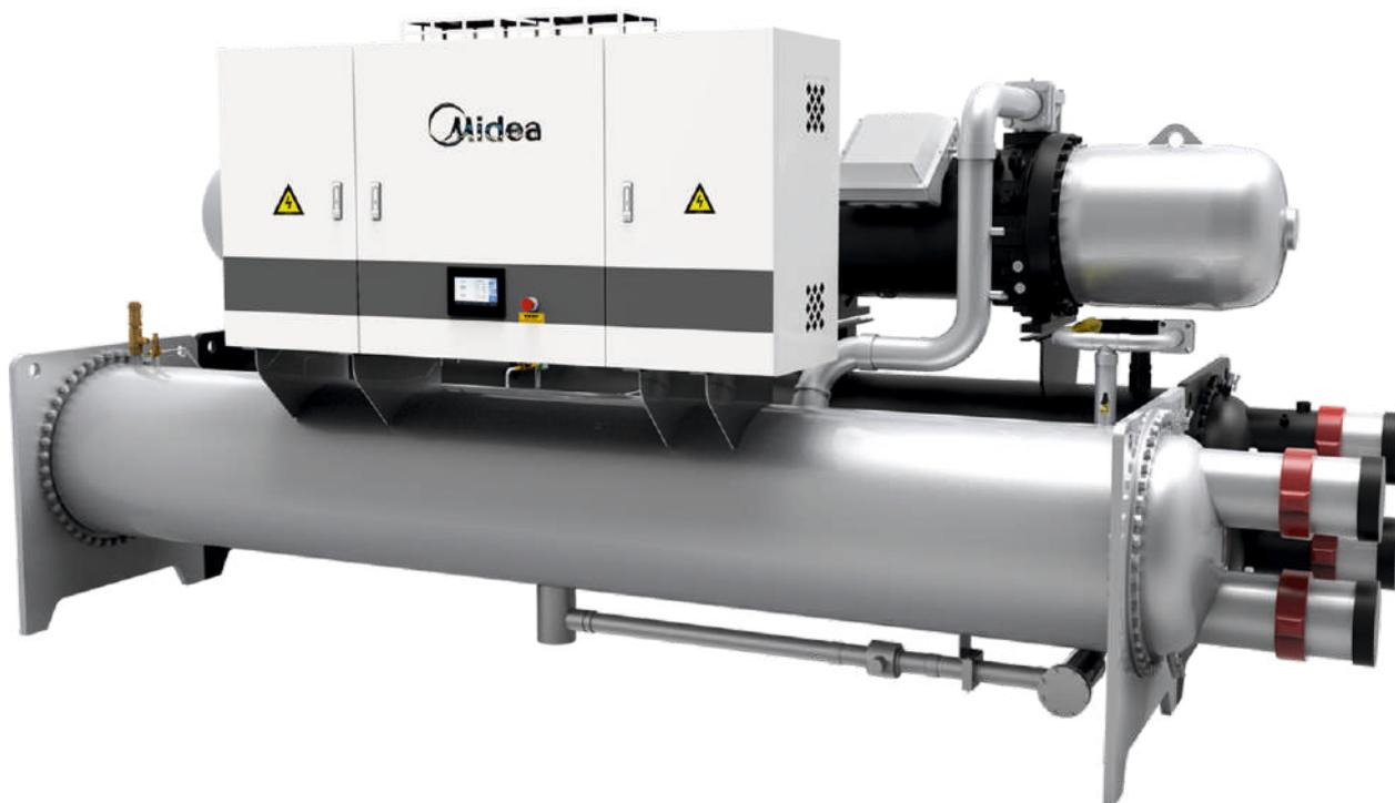
Линейка Aqua Force – это водоохлаждаемые чиллеры на базе винтовых компрессоров Bitzer (Германия). В линейке представлены модели производительностью от 336,9 до 1765 кВт. Применяются в качестве систем центрального кондиционирования, промышленных систем холодоснабжения. Чиллеры могут работать с BMS Modbus и бесплатной программой Midea MSC.
